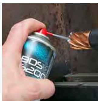
Fase 1: Prima di avviare la macchina, spruzzare lo spray ZHS 400 direttamente dentro e fuori la fresa.
