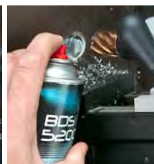
Fase 2: durante l'avanzamento nel foro spruzzare lo ZHS 400 sui taglienti della fresa e all'interno del foro.
